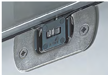
Умная и удобная технология монтажа: двери просто защелкиваются на верхние ходовые элементы без использования какого-либо инструмента. Встроенная регулировка по высоте дает возможность точно выровнять фуги на фасаде.
